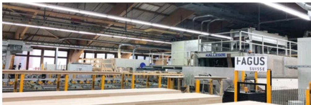
Poutres en hêtre « fraîches de la presse » dans l'usine de production de Fagus Suisse Photo @ Fagus
