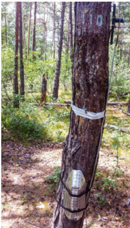
Sous le capot fixé à un pin se trouve un capteur de flux de sève comportant deux fines aiguilles métalliques. Il est utilisé pour déterminer la quantité d'eau qui s'écoule à travers un tronc d'arbre.
