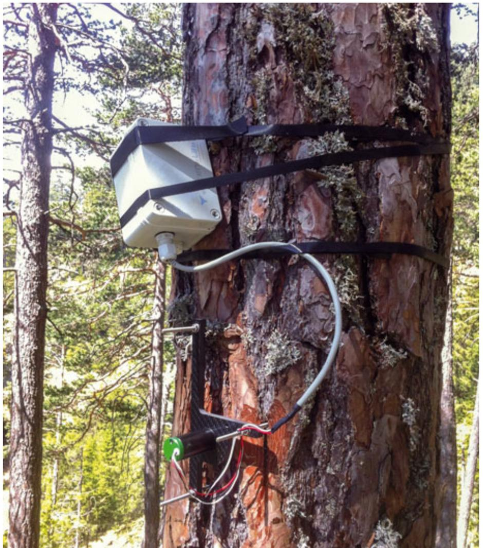
Dendromètre avec deux capteurs sur un tronc de pin sylvestre dans le Bois de Finges. (photo © WSL)
