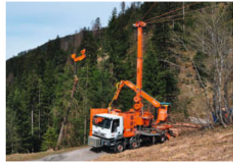
Das Kombiseilgerät ist eine effiziente und sichere Lösung für die Holzernte im Gebirge. Die Bäume werden im Bestand lediglich gefällt, als Vollbäume an die Waldstrasse gerückt und dort mit dem Prozessor aufgearbeitet
