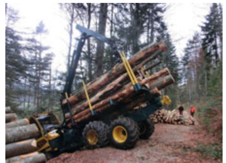
Forwarder mit Tarktionshilfswinde im Einsatz
