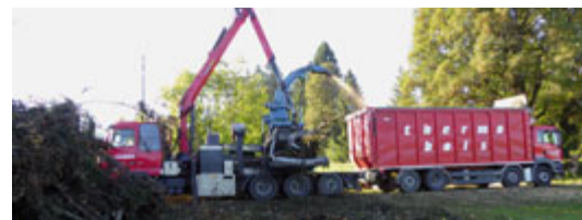
Déchetage en action pour réduire en copeaux un mélange de bois et de branches d'un pâturage qui alimentera des chauffages à distance de la région
