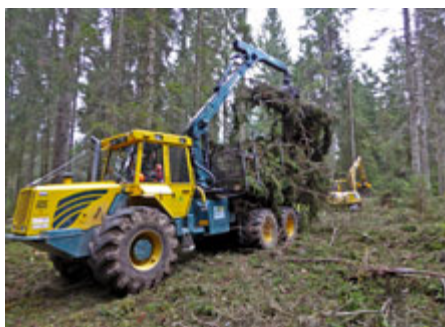
Evacuation des branches jusqu'au lieu de déchiquetage
