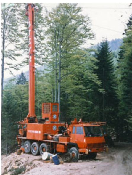
Les gros téléphériques mobiles font leurs premières apparitions dans les forêts du Jura bernois. (photo Gérald Montandon)
