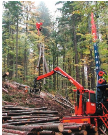
Un câble-grue en action: sans dessertes adéquates, nombre de forêts en Suisse ne peuvent pas être exploitées et suffisamment rajeunies. (photo EFS)
