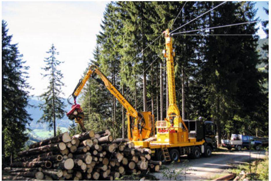
Les propriétaires forestiers demandent un soutien fédéral pour les dessertes forestières. A l'aide de câbles-grues, on pourrait éclaircir de nombreuses forêts vieillissantes et favoriser leur rajeunissement. (Photo: EFS)
