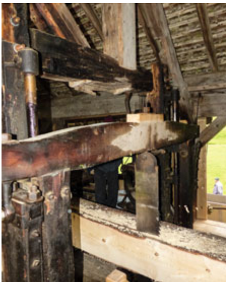
Cadre à scie verticale à une seule lame actionnée par une roue à augets qui est alimentée par l'eau de la Trame.
