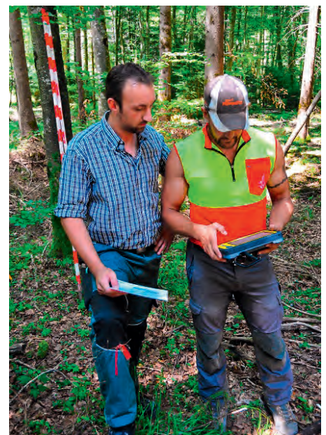
▲ Ausnivellieren der Station und Koppelung von Totalstation und Prisma mittels Tablet-PC.
