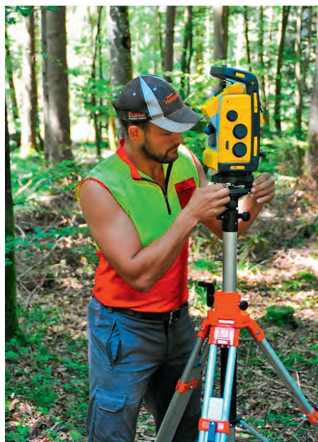
▲ Ausnivellieren der Station und Koppelung von Totalstation und Prisma mittels Tablet-PC.
