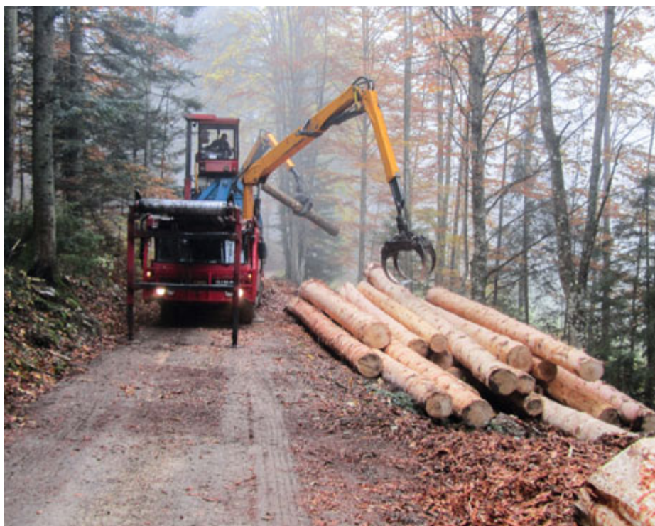
Ecorceuse mobile en action
