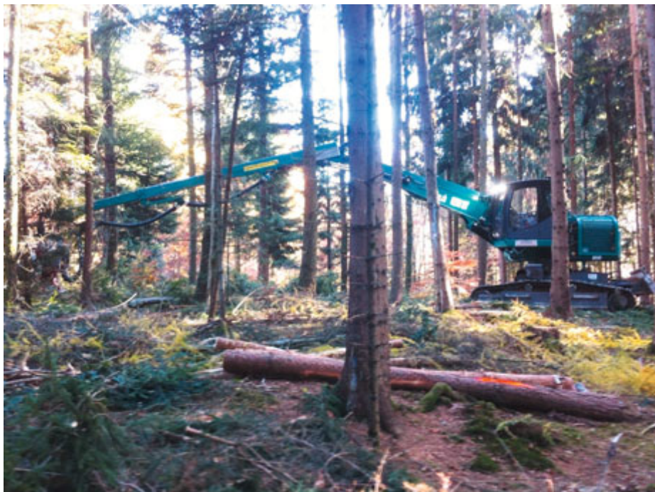
Abb. 1: Der Königstiger in voller Länge. Bei 15m Ausladung noch 3 t Hubkraft
