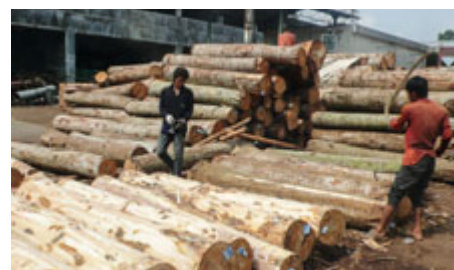
Albizia f., écorçage et conditionnement billes de déroulage, scierie ind. Temanggung, île de Java centrale
