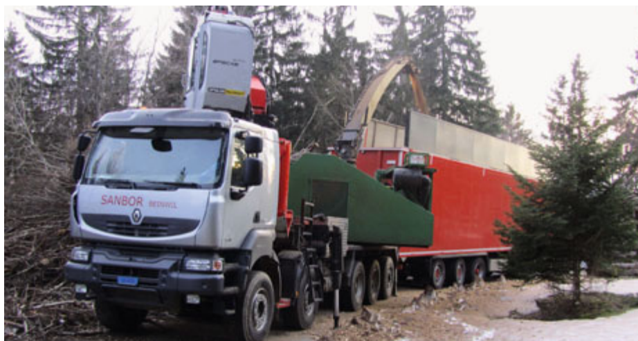
Remplissage d'une benne par la déchiqueteuse
