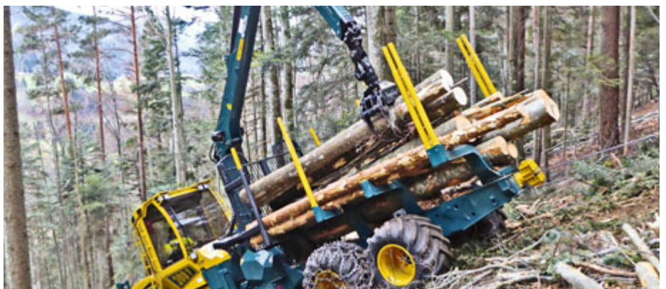
Porteur de marque HSM 208 F muni d'un treuil de traction évoluant avec une méthode de récolte mécanisée en terrain praticable dans une pente forte à très forte de la Commune mixte de Petit-Val
