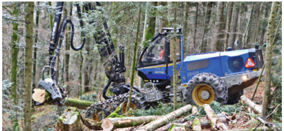
Récolteuse Rottne H-14 munie de chaînes et de chenilles évoluant avec une méthode de récolte mécanisée en terrain praticable dans une forêt à faible pente de la Bourgeoisie de Saicourt
