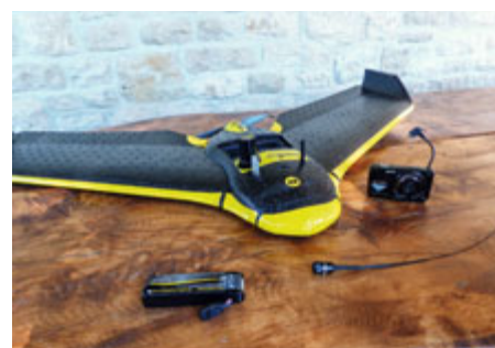
Le drone avec à gauche l'accumulateur, au centre la balise de détresse et à droite l'appareil de photo. Monté sur le drone, le GPS différentiel. (Source pyv)
