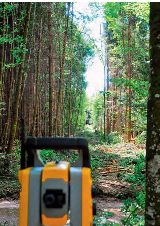
Totalstation gesteuerter Harvester beim Aufschneiden der Rückegasse.
