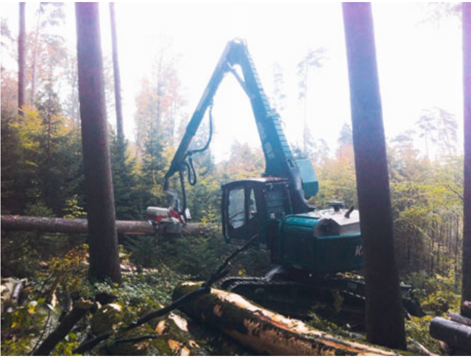
Abb. 3: Mit seiner Hubkraft hebt er auch Schwergewichte aus dem Jungwuchs. Dank dem Raupenfahrwerk wird dabei der Bodendruck auf 5.4 qm verteilt.
