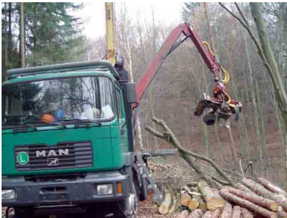
Câble-grue Mounthy 4000 avec processeur actionné par la fille de l'entrepreneur, Adelaïde Höllwart
