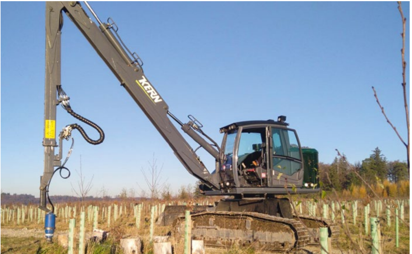
Mit dem teilmechanisierten Krümlerverfahren wird gepflanzten Bäumen ein optimaler Start in die Zukunft ermöglicht.
