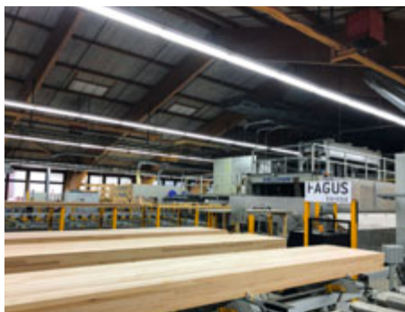
Produktionswerk in Les Breuleux. Fertige Träger mit neuer Holzästhetik aus Fagus Stabbuche.
